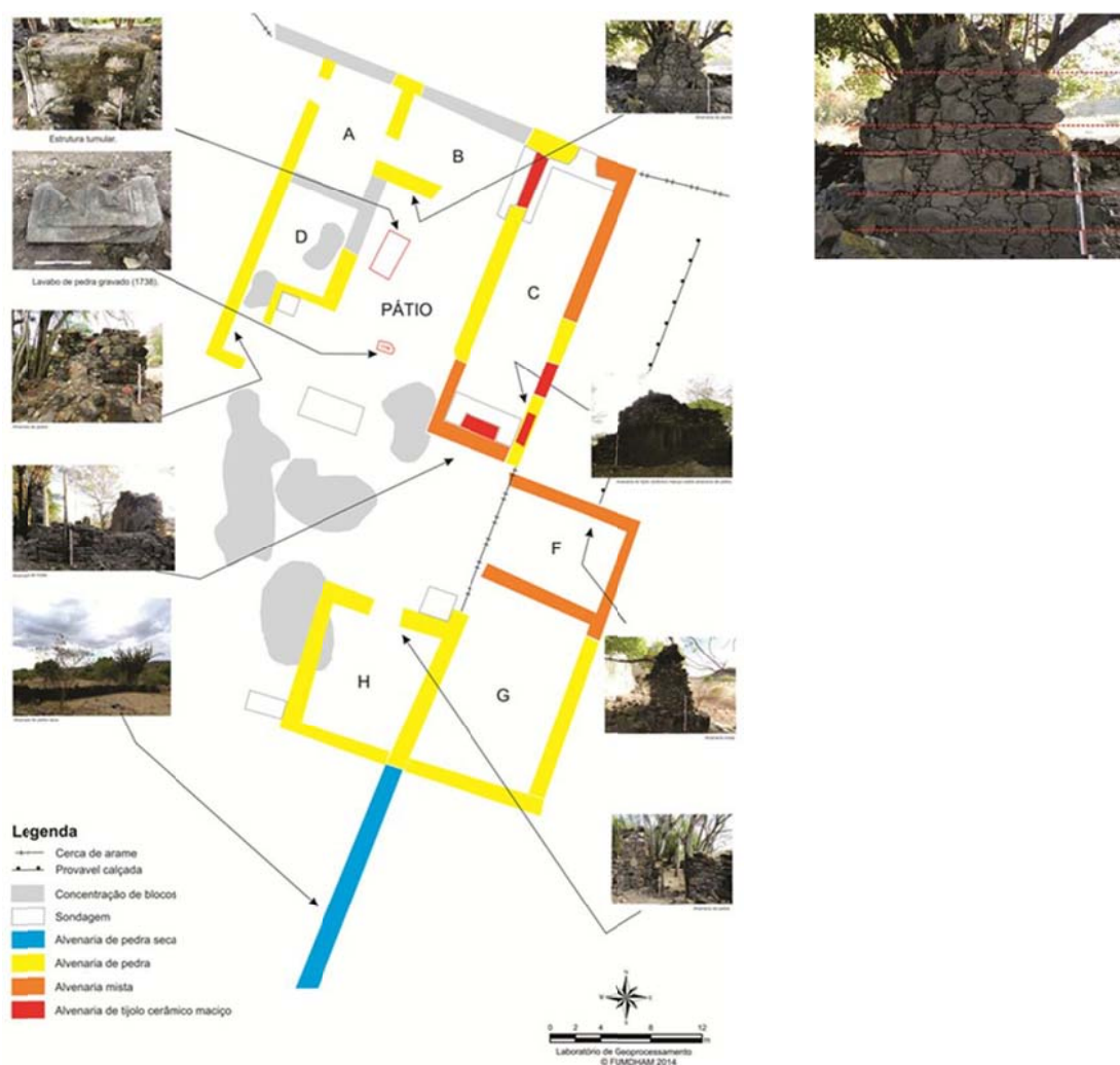
Figura 6: Planta baixa e detalhes com indicação de padrões de alvenarias nos vestígios da antiga fazenda jesuíta, composta por várias construções contíguas entre si, organizadas em quadra, formando um pátio central. Em amarelo, as paredes com alvenaria de rocha. No detalhe maior no alto, exemplo no qual, embora com formatos e tamanhos variados de rochas, manteve-se o nível das prumadas horizontais.
