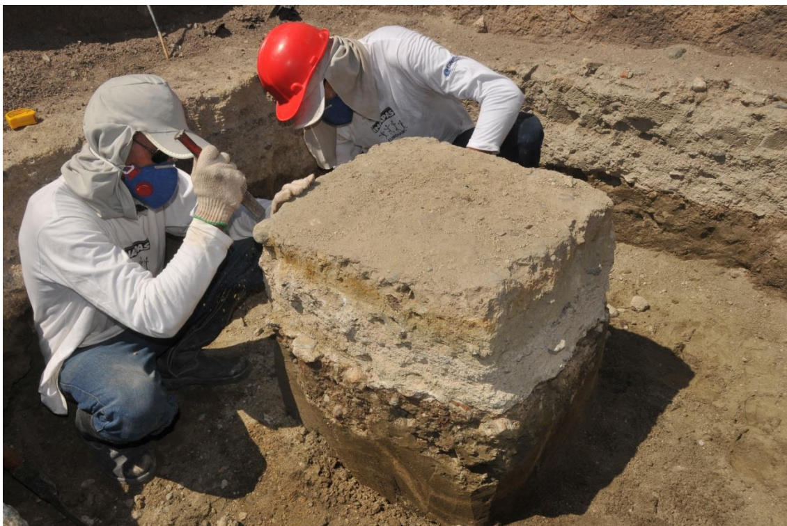
Figura 3: Preparação em campo de amostra de concreção carbonática do Sítio Lagoa Uri de Cima.
