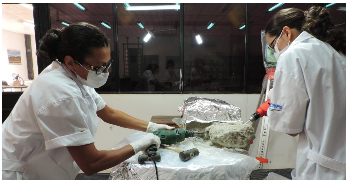
Figura 9: Retirada de amostra de sedimento extremamente compactado evidenciado no perfil Leste da placa de concreção 31.
